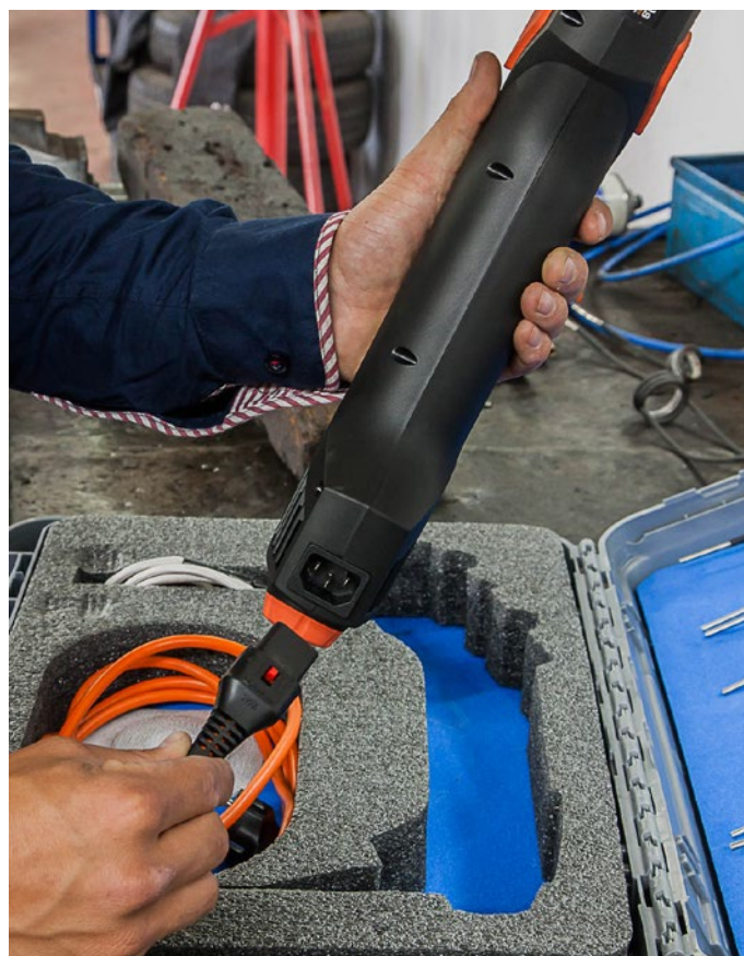
intelligente Lösung: Netzkabel mit IEC Lock an dem Elektrowerkzeug
