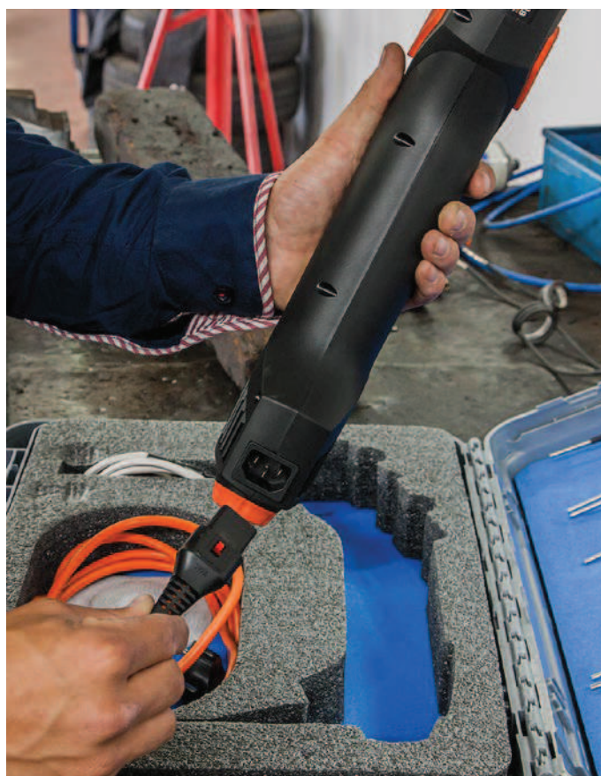
Unieke toepassing van een IEC Lock stekker in combinatie van elektrisch handgereedschap
